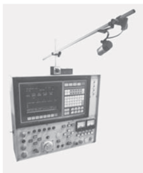
操作盤の表示を撮影するカメラを設置
