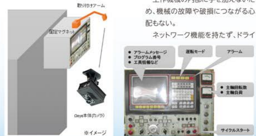
操作盤をカメラで撮り、画像認識でデータ化する
